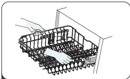
**1** Pour relever le panier supérieur, soulevez le panier au centre de chaque côté jusqu'à ce que le panier se verrouille en position haute. Il n'est pas nécessaire de soulever la poignée de réglage.
